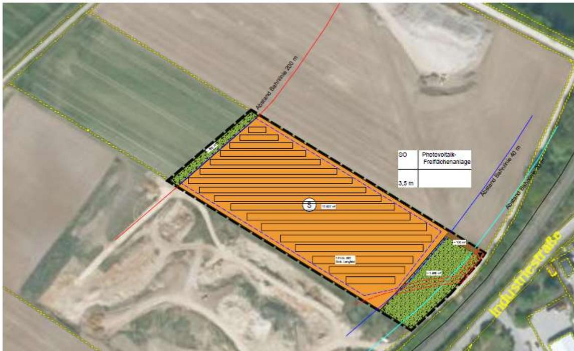
Die geplante Freiflächenphotovoltaikanlage befindet sich innerhalb des 20 m und des 200 m Abstands von der Bahnlinie.
